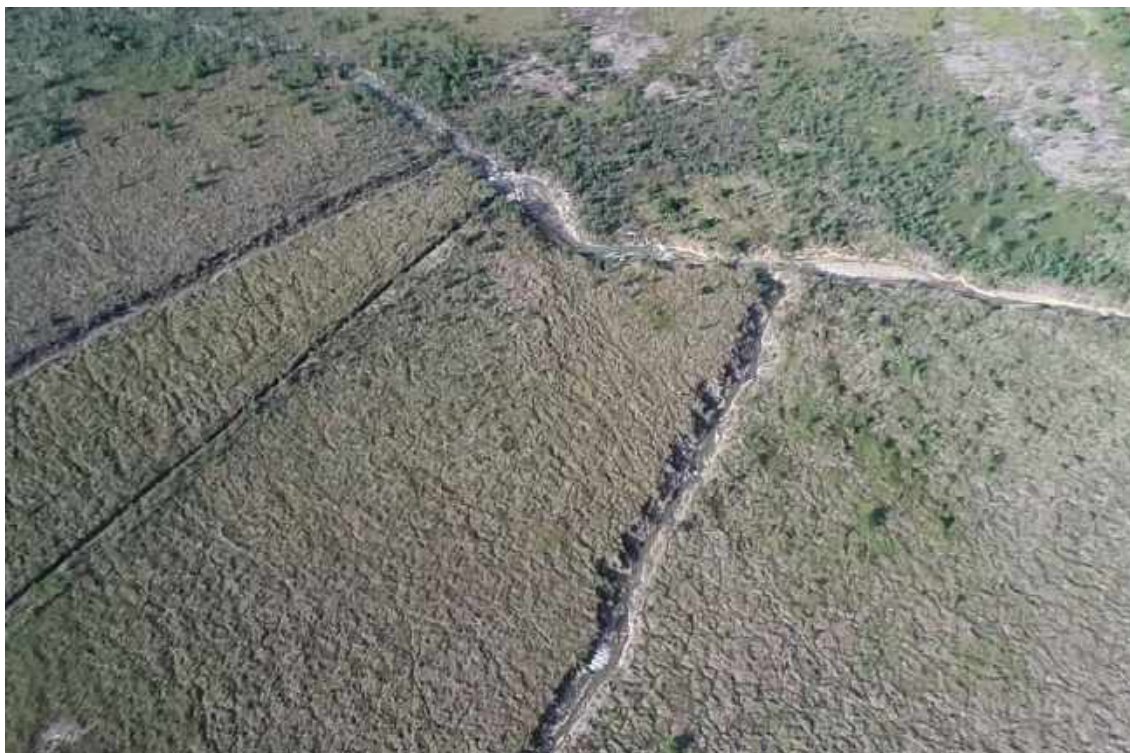
Figura 124. Imagem do processo erosivo nos drenos na Fazenda Gramado. Coordenadas: Lat - 21°23'41.00"S; Long - 56°35'24.23"O.
