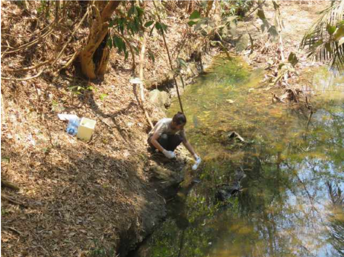
Figura 182. Coleta de água para análise bacteriológica.
