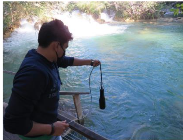
Monitoramento físico-químico com sonda multiparâmetros, maio de 2020 - Rio Formoso
