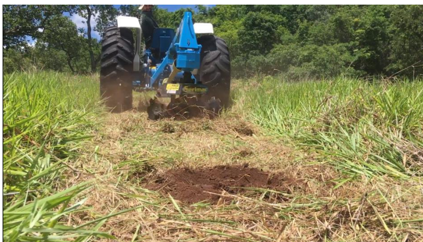
Figura 5: Abertura de covas com um perfurados hidráulico.
