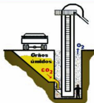
01. Esquema de produção de dióxido de carbono na moega de recepção.
